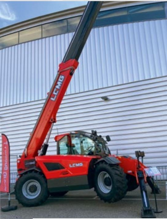
LGMGs erster Teleskoplader für den CE-Markt, der HT1840 (17,6 Meter/4 Tonnen)
