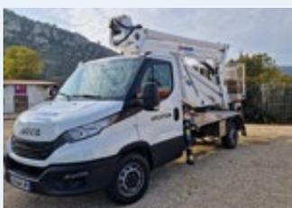
↑ Das französische Vermietunternehmen **Labrosse Material Solution BTP** hat seine erste **CTE Zeta 22** LKW-Arbeitsbühne in seine Flotte aufgenommen. Die neue Maschine verfügt über einen zweiteiligen Gelenkarm, wodurch der Gelenkpunkt bei 9,80 Meter liegt. Die maximale Reichweite beträgt etwas mehr als zehn Meter mit 100 Kilogramm Korblast oder 7,50 Meter mit der maximalen Korblast von 250 Kilogramm.
