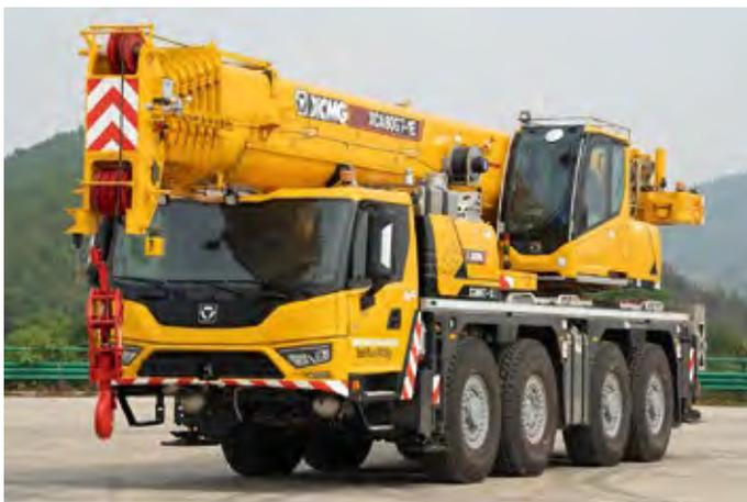
Einen neuen 80-Tonner für den europäischen Markt hat XCMG vorgestellt. In den Niederlanden wurden bereits mehrere Exemplare des XCA80G7-1E verkauft. Der neue 4-Achser verfügt über einen sieben-teiligen 60-Meter-Hauptausleger, an den sich eine 9,5 bis 16 Meter lange Doppelklappspitze anschließt, die um bis zu 40 Grad steilgestellt werden kann. Die maximale Hakenhöhe beträgt knapp 80 Meter.
