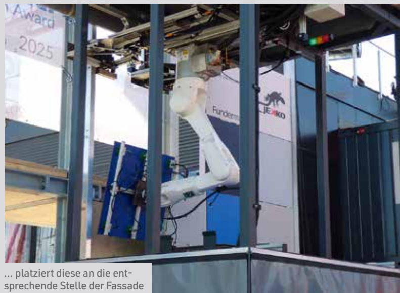
Der Roboter greift die Paneele und ...
