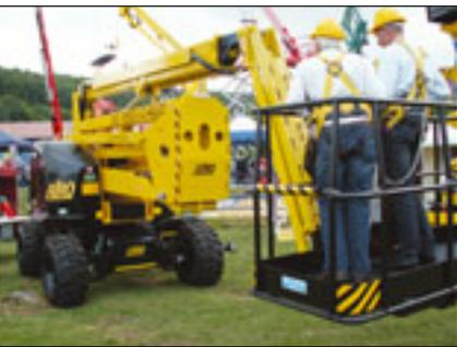
Von der technischen Seite fiel die Genie Z51/30 in vielen Punkten positiv auf. Die Elektronikeinheit und deren Verkabelung ist übersichtlich und gut. Die Verlegung der Kabel und Schläuche ist dergestalt, dass diese gut geschützt verlaufen. Der herauschwenkbare Motorblock macht den Zugang an einzelne Bereiche und damit die Wartung leichter. Die meisten Elemente sind auch gut gegen
