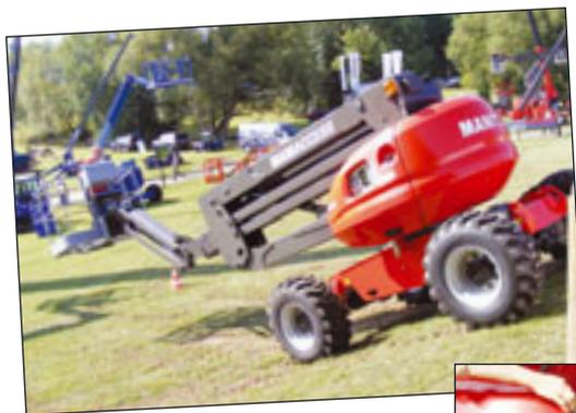
Punkten wie der Verlegung der Hydraulik, dem Feuchtigkeitsschutz, der Lackierung und der Stabilität überzeugte das Gerät. Ein Manko ist die Erreichbarkeit
