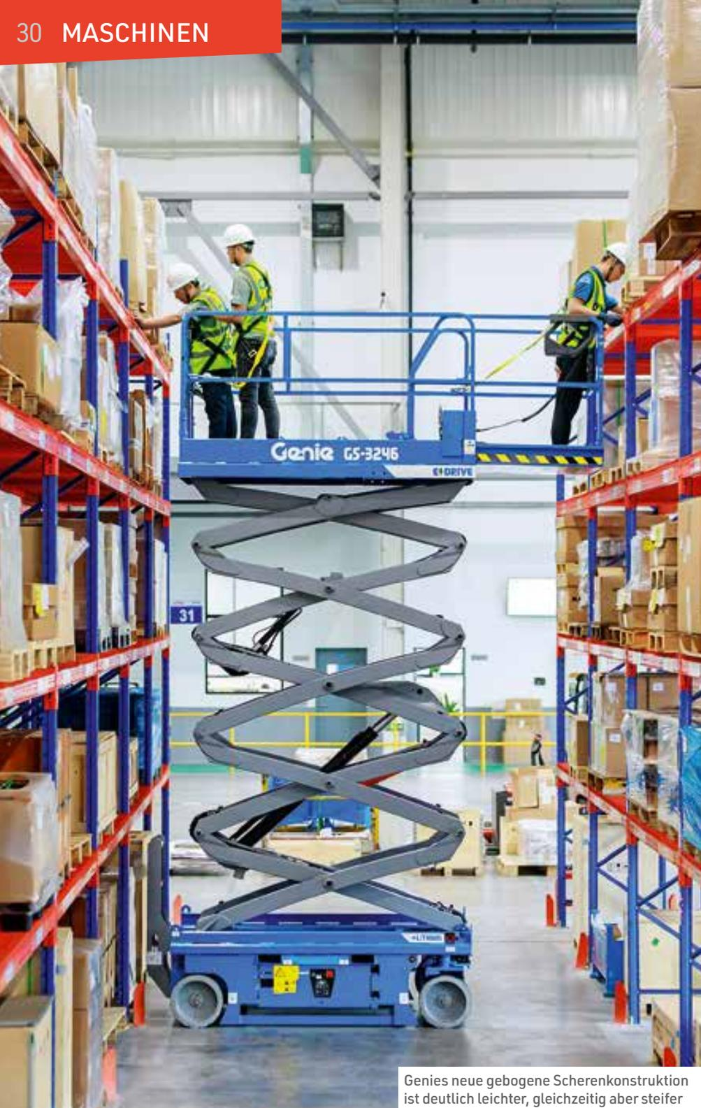
Genies neue gebogene Scherenkonstruktion ist deutlich leichter, gleichzeitig aber steifer
