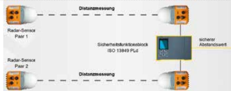
mit vier LPR 1D24 für eine Reichweite von bis zu 1.000 Metern. Das System ist derzeit in der Zertifizierung nach ISO 13849.
