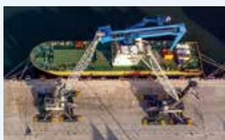
↑ Der rumänische Containerterminalbetreiber **DP World Constanța** erweitert seine Kapazitäten um zwei Hafenmobilkrane des Typs LHM 600 aus dem Hause **Liebherr**. Das zweitgrößte Modell der Palette ermöglicht Tandemhöhe bis 400 Tonnen, arbeitet mit Elektroantrieb und ist mit einem 360-Grad-Kamerasystemen ausgestattet.
