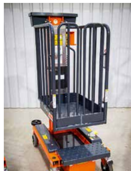
Der Nano von Power Towers 35 kann ganz ohne Strom den Anwender bis in 3,50 Arbeitshöhe bringen
