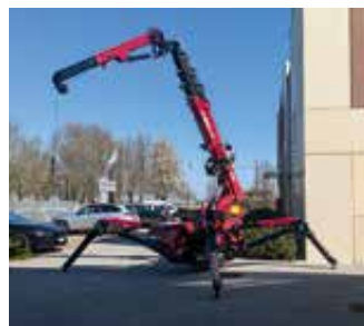
Am Stand von Kunze wird der Minikran MCX110 mit 79 Zentimeter Baubreite gezeigt.
