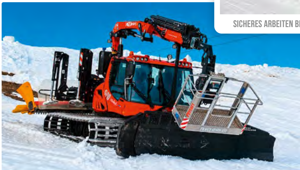
EIN PISTENBULLI MIT LADEKРАН VON TADANO-PM UND ARBEITSKORB
