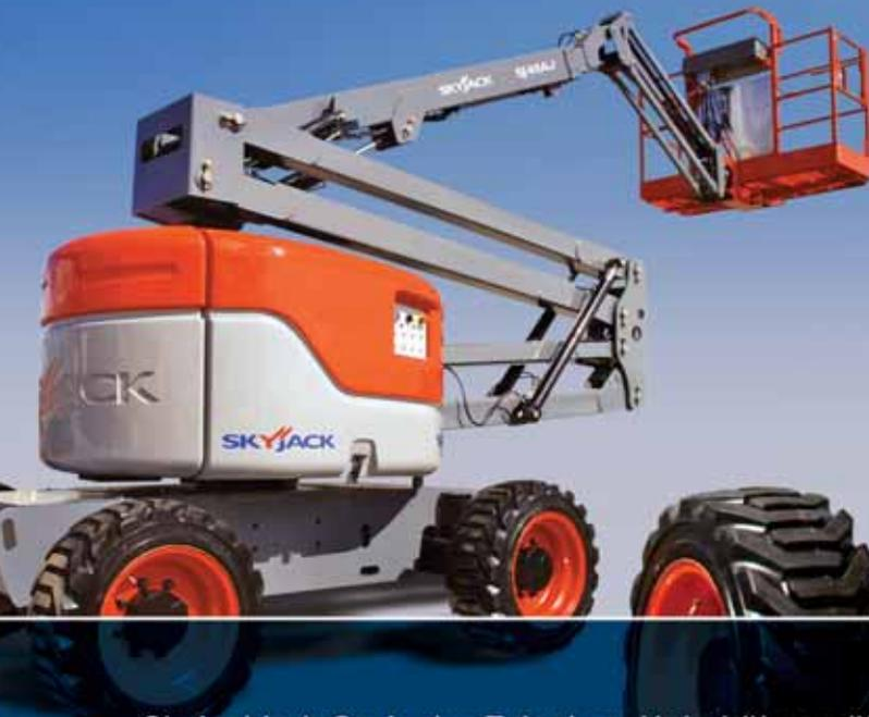
Skyjack's A-Serie der Teleskop-Hebebühnen übertrifft alles auf dem Markt da gewesene. Standardmäßige 360 Grad endlos Drehkranzdrehung, null Heckausladung, achsbasierender Allradantrieb und Richtungsüberwachung der Fahr- und Lenkfunktion, echtes Senkrechtsteigen ohne Vorwärts- und/oder Rückwärtsdriften. Die A-Serien Modelle sind in 2 Ausführungen erhältlich: SJ 46AJ und SJ 51 AJ.
