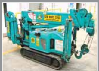
MAEDA MC104 CR-G Mini crane 5.50m/1 Tonne - 2003
