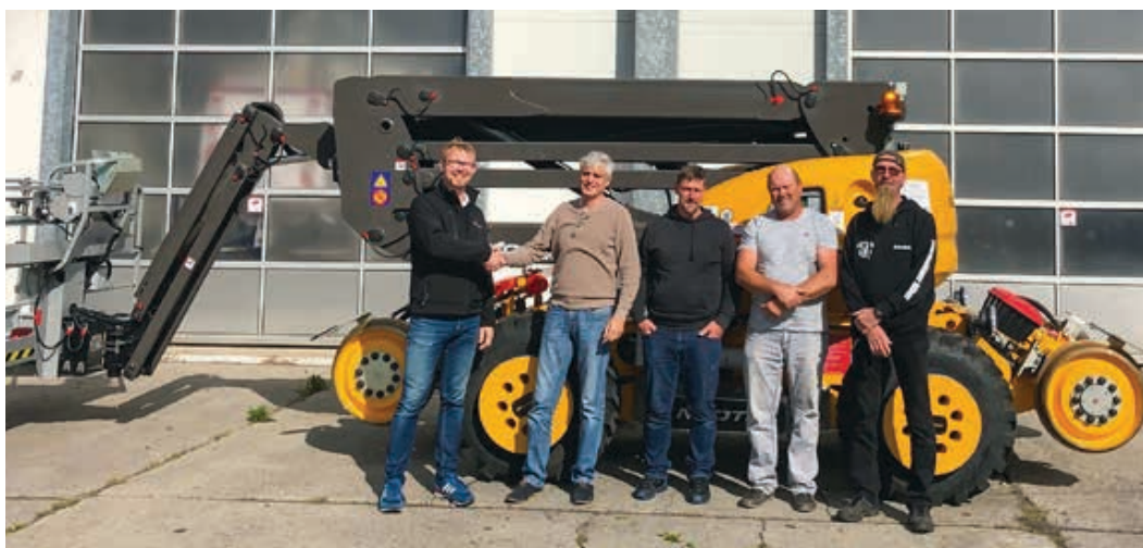
Die Furrer+Frey Deutschland GmbH hat ihre neue Zwei-Wege-Hubarbeitsbühne vom Typ Neotec Skyrailer 400 übernommen. Mit der Arbeitshöhe von 16,20 Meter, einer seitlichen Reichweite von 8,60 Meter sowie der Korblast von 400 Kilogramm kommt der Skyrailer auf Deutschlands Schienennetz zum Einsatz.
