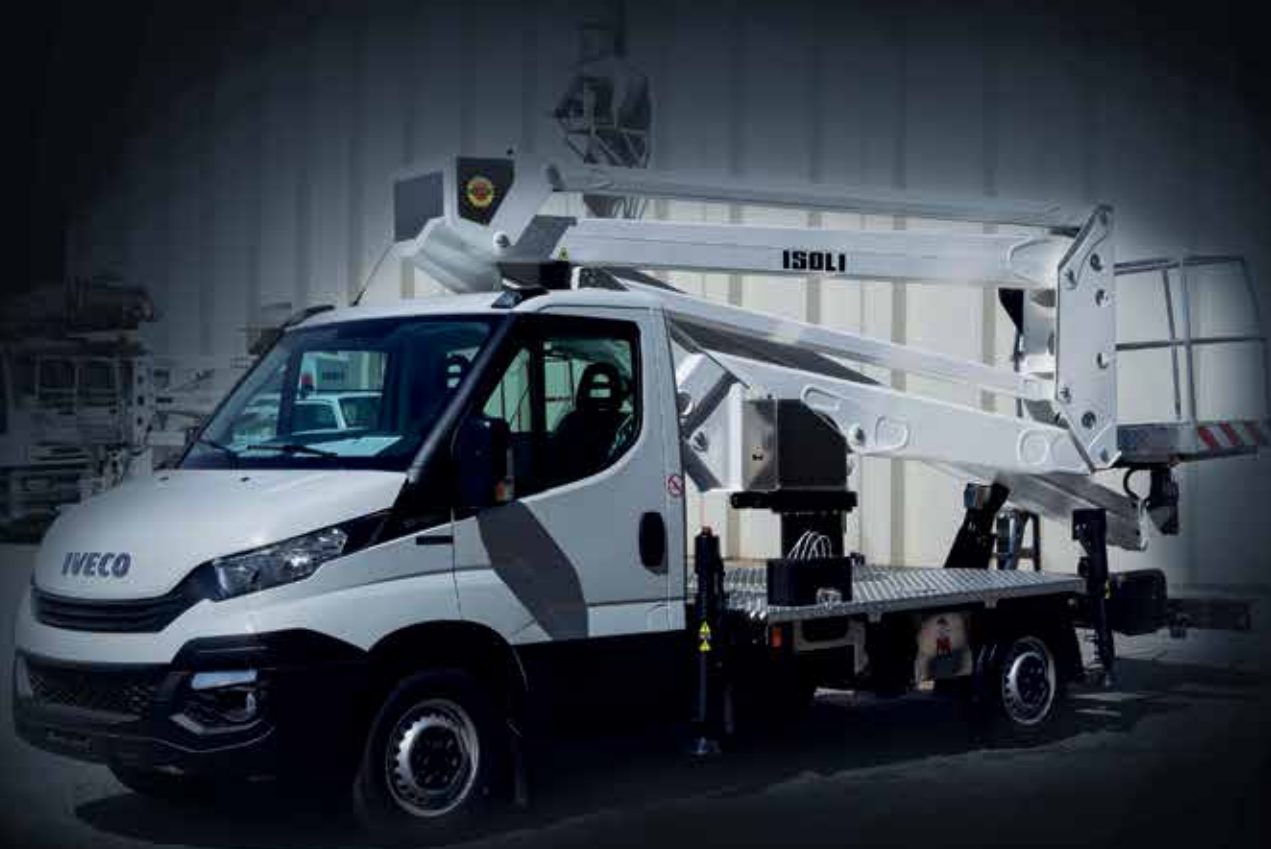
ISOLI PNT 215HE3 – Gelenk-Teleskop auf IVECO Fahrgestell
